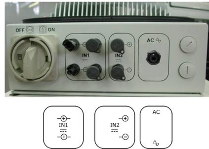
Bevor Sie nun die Strangleitungen am Wechselrichter auflegen, vergewissern Sie sich, dass die Polarität der Plus- und Minus-Strangleitung mit der Eingangspolarität am Wechselrichter übereinstimmt. Bei einer Vertauschung der Polarität bleibt die Anzeige im Display des WR dunkel, es werden keine Parameter angezeigt. Für den Anschluss werden wie auf der Generatorsseite Anschlusssets angeboten.
