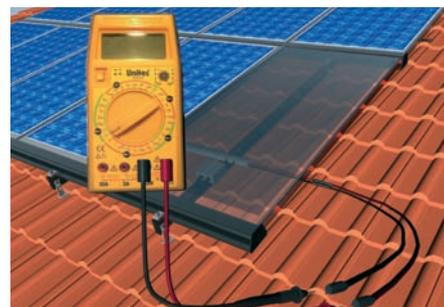
Die maximalen Leerlaufspannung U<sub>oc</sub> ist jedoch nur bei einer Lichtleistung von 1000W/m<sup>2</sup> und einer senkrechten Einstrahlung auf die Modulfläche zu erwarten. Die Angaben auf dem Typenschild gelten also nur unter STC-Bedingungen (1000W/m<sup>2</sup>, 25°C, AirMass 1,5).
